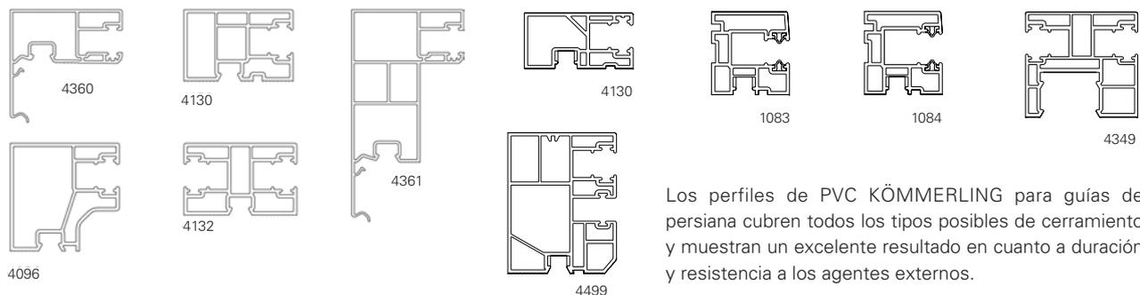
Los perfiles de PVC KÖMMERLING para guías de persiana cubren todos los tipos posibles de cerramiento y muestran un excelente resultado en cuanto a duración y resistencia a los agentes externos.
